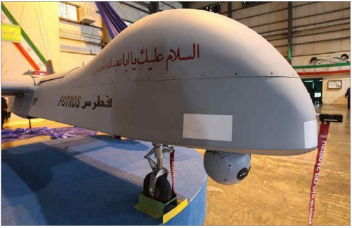
«فطرس»، پهپاد ایرانی که بیش از همه شکاف و شکل محل اتصال بخش فوقانی و تحتانی بدنه‌ی آن نقص بزرگی است
